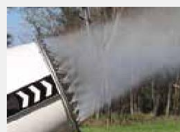
Коронка из нержавеющей стали с 24 соплами
